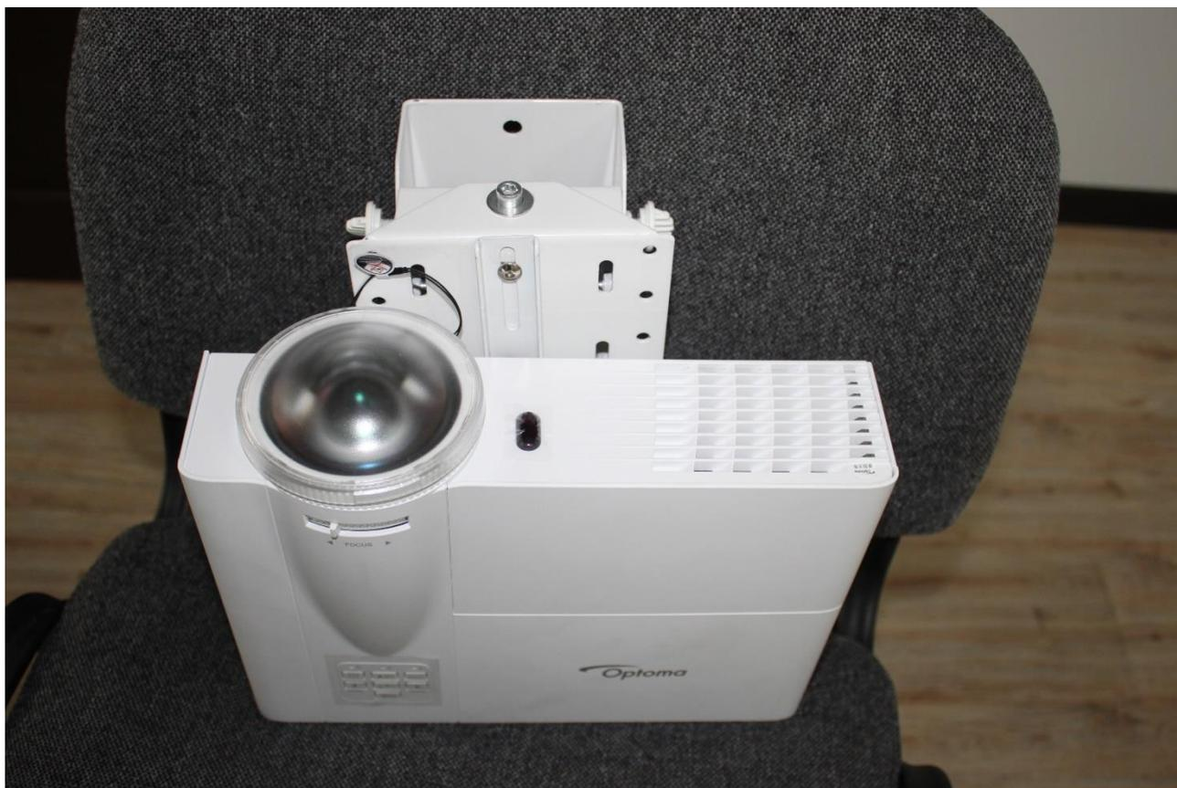
**Шаг 4.** «Оденьте» сборку проектора на кронштейн доски («ногу»). Включите проектор и отрегулируйте засветку рабочей поверхности доски. Для этого можно изменять положение проектора физически.
