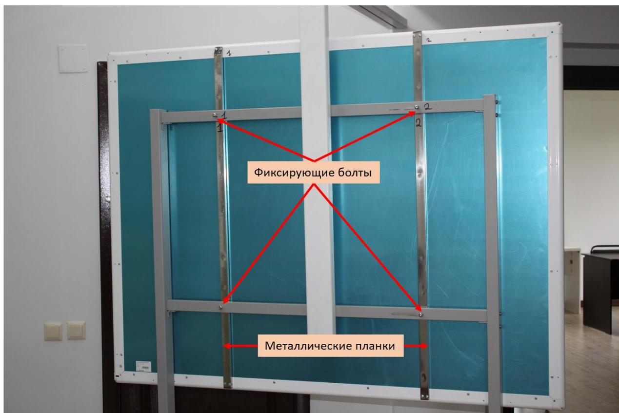
**Шаг 2.** Соедините доску с планками при помощи болтов, используя специальные крепежные отверстия.
