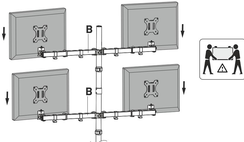
4б. Зафиксируйте VESA панели (A) с помощью винтов (J) через проставки (I). Поверните ключом (Q) по часовой стрелке, чтобы затянуть винты после установки мониторов под нужным углом. Перед регулировкой угла наклона немножко ослабьте винты.
