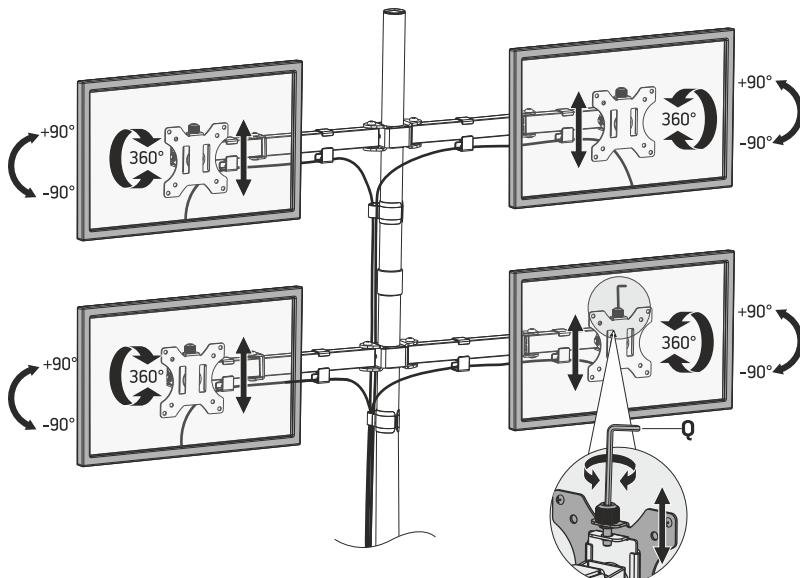
**ВАЖНО!** Затягивайте винты с усилием **НЕ БОЛЬШИМ**, чем достаточно для надежного крепления кронштейна. Чрезмерно приложенное усилие при затягивании крепежных винтов может привести к повреждению кронштейна.
