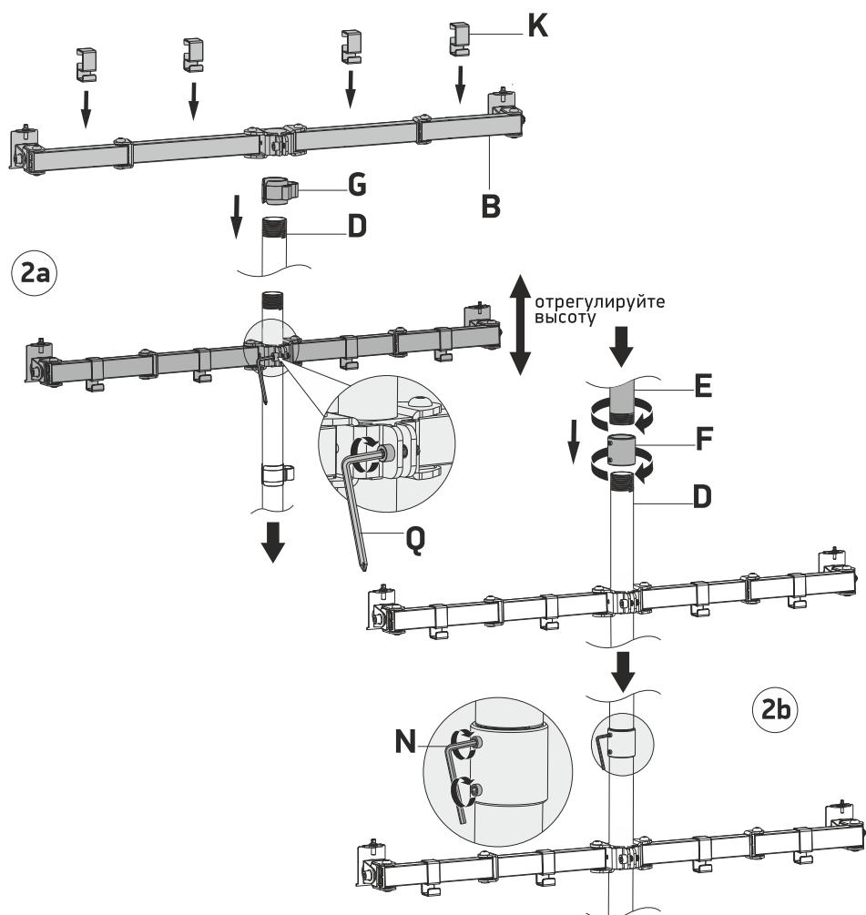
**2с.** Установите пластиковые крюки (К) на верхнее плечо кронштейна (В). Наденьте держатель кабеля (Г) на трубу кронштейна (Е). Отрегулируйте желаемую высоту и затяните болты с помощью ключа (Q).
